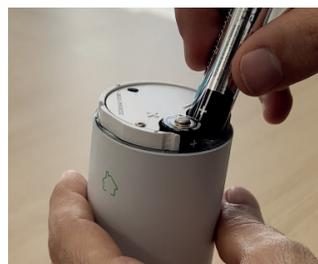
3) Svitare e rimuovere il coperchio della valvola TRV+AA e inserire le pile AA rispettandone la polarità.
