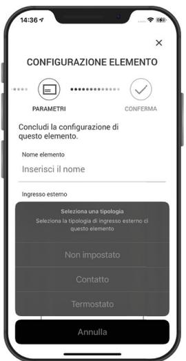
Fig.8 Funzione sonda di temperatura. Attribuire un nome all'elemento, quindi selezionare la tipologia di ingresso.
