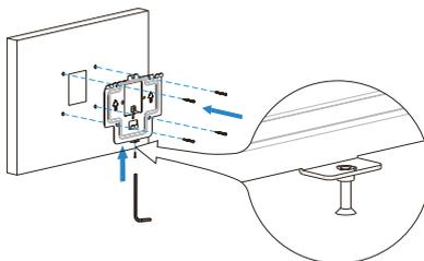
Fissare al muro la staffa di montaggio (fornita nella confezione).
