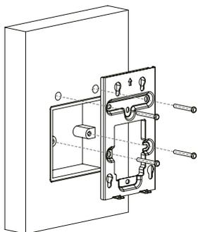
Installazione con scatola da incasso e staffa di montaggio.
