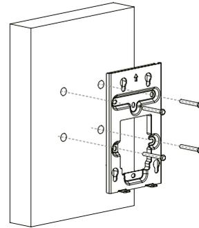
Installazione a muro senza scatola da incasso e con staffa di montaggio
