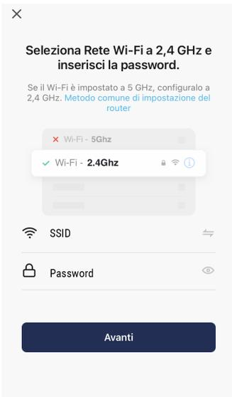
Inserire l'SSID e la password della rete a cui si vuole connettere il termostato. N.B: verificare che la rete sia a 2.4 GHz.
